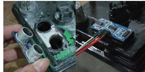
Gambar 2.3 Sensor HCSR04 untuk membaca ketinggian air aki
