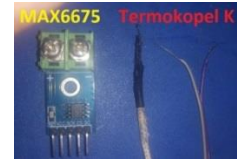
Gambar 2.2 Sensor Termokopel K untuk membaca suhu gas buang
