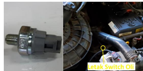
Gambar 2.5 Sensor Switch Oli untuk membaca tekanan oli
