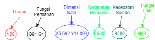
Gambar 2. Variasi Perintah G-Code
