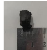
Gambar 15 Ukuran Pecahan Arang Terbesar Setelah Masuk Sistem Crushing yaitu 1 CM
