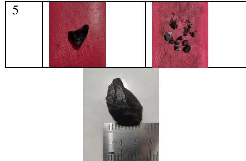
Gambar 14 Ukuran Arang Sebelum Masuk Sistem Crushing yaitu 2.5 CM
