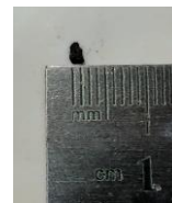
Gambar 16 Ukuran Pecahan Arang Terkecil Setelah Masuk Sistem Crushing yaitu 1 MM
